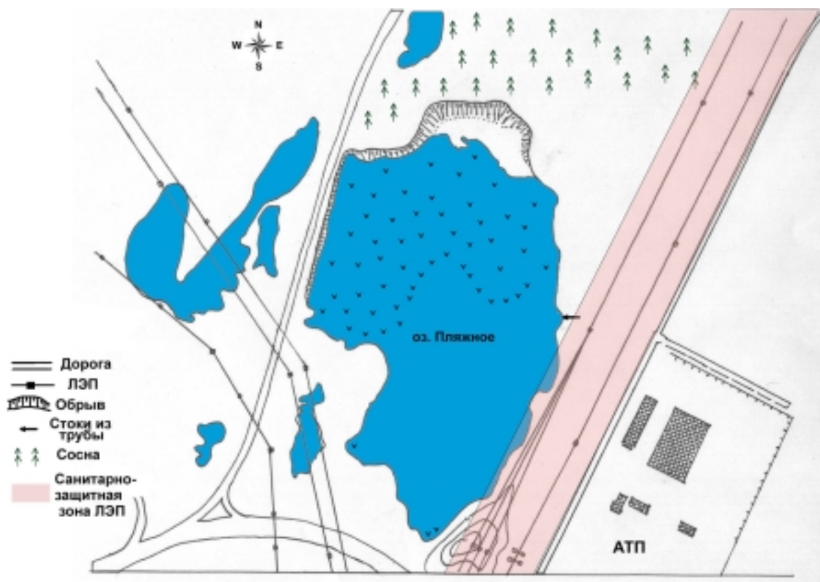
Схема оз.Пляжное с указанием установленной санитарно-защитной зоны воздушных линий электропередачи.
